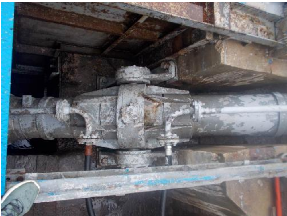
1) Uchycení válce D 400 ke spodní stavbě
